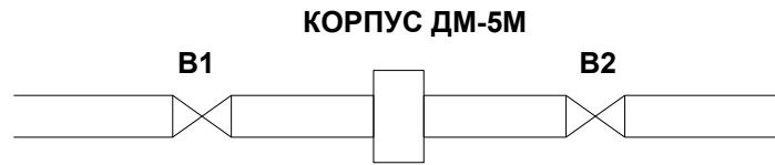
Рисунок 5 - Схема непосредственной врезки арматуры ДМ-5М
